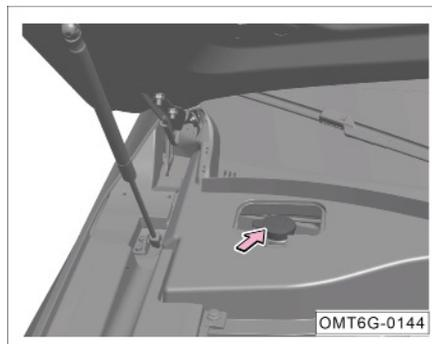
2. При обнаружении слишком низкого уровня жидкости стеклоомывателя необходимо своевременно долить жидкость стеклоомывателя в бачок стеклоомывателя.
