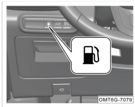
1. Нажмите кнопку открывания заправочной горловины топливного бака
