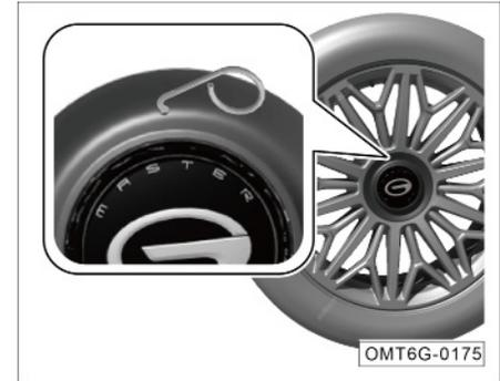
1. Перед снятием колеса необходимо сначала снять декоративную крышку. С помощью инструмента для снятия декоративной крышки подденьте крышку через небольшое отверстие.
