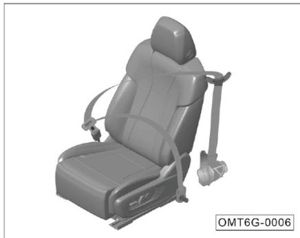
В случае столкновения правильно пристегнутый ремень безопасности позволяет удерживать водителя и пассажира на месте, предотвратить их перемещение по инерции, обеспечить наибольшую эффективность подушек безопасности и минимизировать повреждения.
