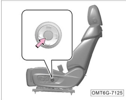
Переведите питание автомобиля в режим ON и одновременно нажмите центральную кнопку регулировки поясничного упора, чтобы включить функцию массажа в сиденье. Нажмите еще раз, чтобы выключить функцию массажа.
