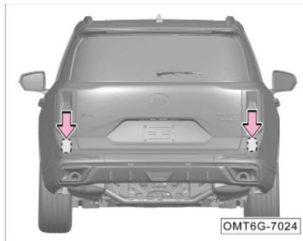
Места установки радарных датчиков системы контроля слепых зон показаны на рисунке выше.
