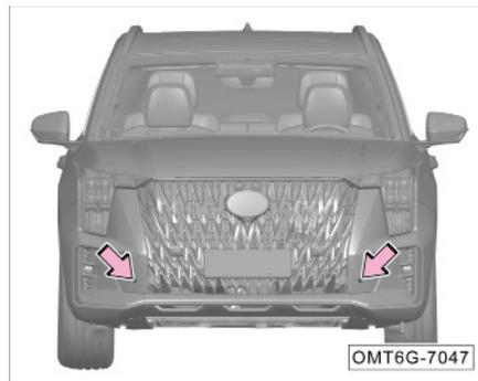
Передний ультразвуковой датчик установлен на крышке переднего бампера.
