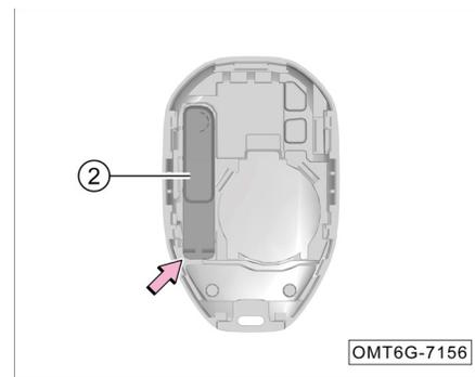
2. В соответствии с направлением стрелки ② поднимите аварийный механический ключ.
