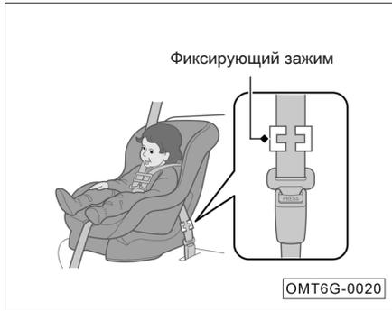
Если детское кресло не имеет устройства для крепления ремня безопасности, установите на ремне безопасности фиксирующий зажим.
