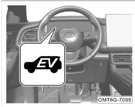
Когда движение автомобиля осуществляется только с помощью тягового электродвигателя или двигатель внутреннего сгорания выключен, загорается световой индикатор EV.
