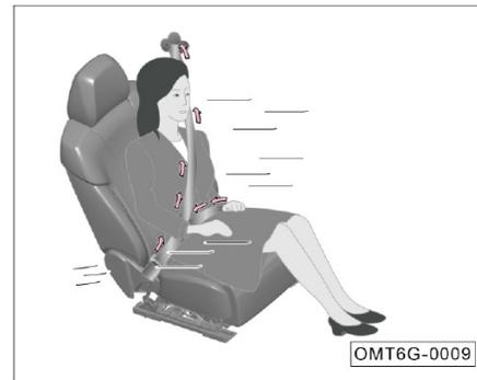
Ограничитель усилия предварительного натяжения ремня безопасности позволяет снизить давление на грудь пристегнутого человека в случае аварии и улучшить защитные характеристики ремня безопасности.
