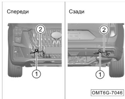
2. Достаньте из ящика с бортовым инструментом, находящегося в багажном отделении, буксировочную проушину ① и баллонный ключ ②.
