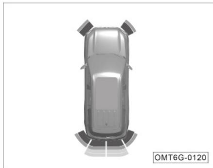
Во время работы системы в левой части дисплея появится динамическое изображение автомобиля. На нем будет отображаться расстояние до объектов впереди и позади Вашего автомобиля. Если смотреть от изображения автомобиля, полосы, изображающие сигналы датчиков, располагаются в следующем порядке: красная, оранжевая, две желтых. По мере приближения к препятствию их количество будет уменьшаться, начиная с более светлых полос.
