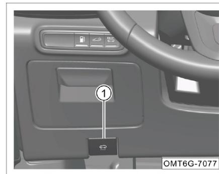
Дважды потяните за рычаг открывания капота ① под приборной панелью со стороны водителя; капот слегка приподнимется и полностью разблокируется, после чего его можно открыть снаружи.
